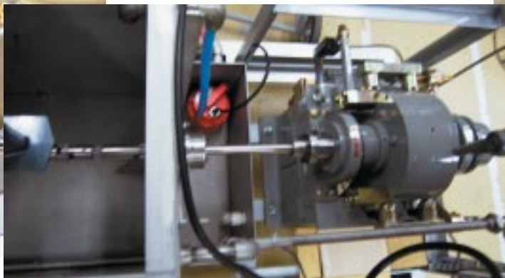
EWS - 20 - Lによる船外機 プロペラ出力軸動力性能試験
