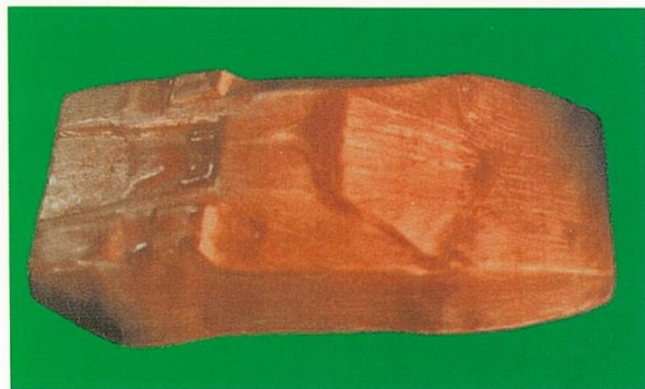
油膜法による自動車の流線観察
